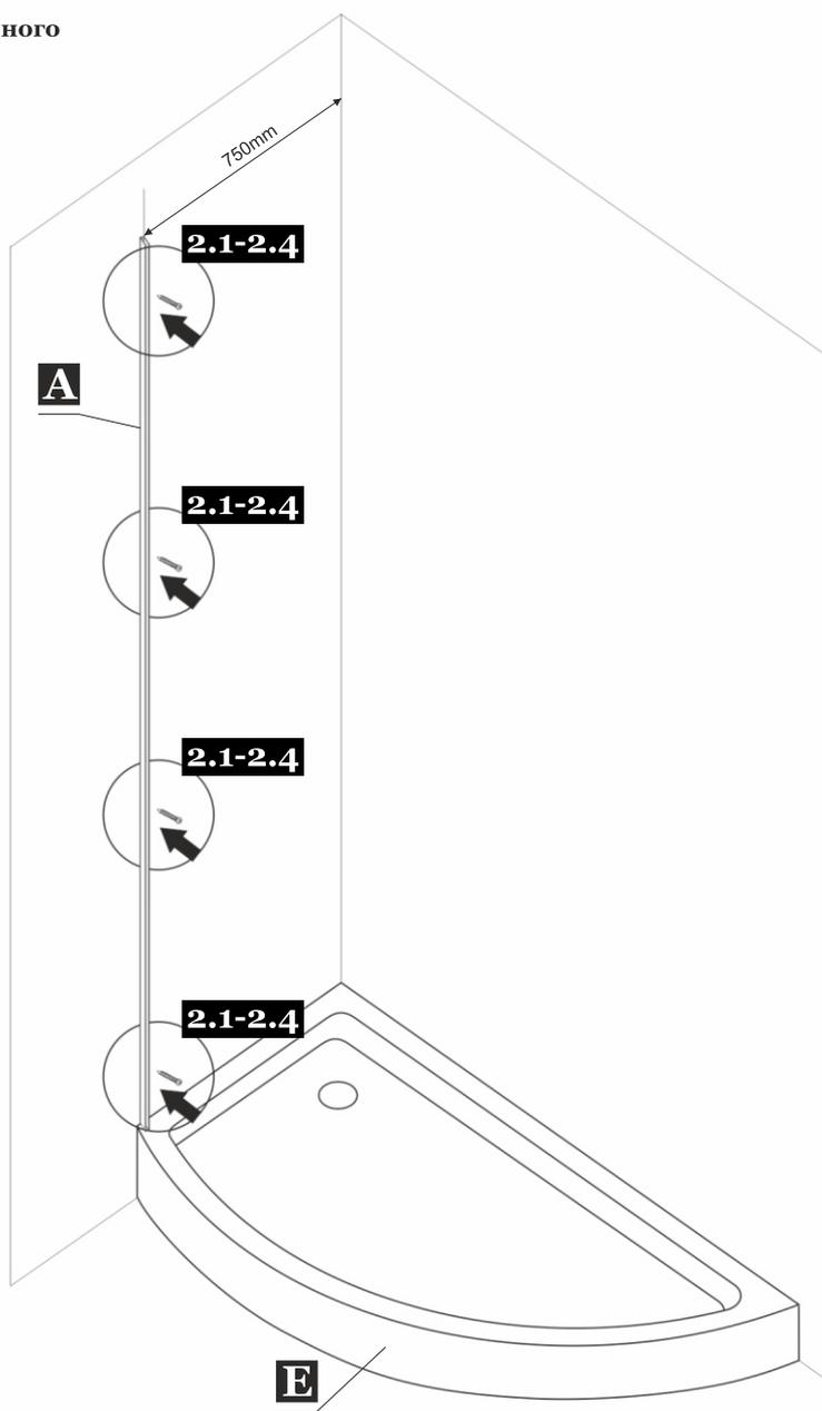
**3** Установить стационарную стеклянную загородку с профилем
